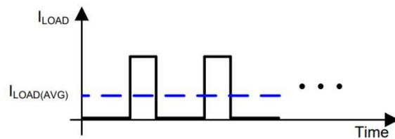
由于芯片的瞬态电流很小，一般可以忽略，故假设输入电流等于输出电流，则芯片的功耗  $P_D$  可计算为输入电压和输出电压的压差乘以电流，即得公式  $P_D = (V_{IN} - V_{OUT}) \times I_{IN}$  由于输入电流也等于负载电流，因此可得公式  $P_D = (V_{IN} - V_{OUT}) \times I_{LOAD}$  但由于瞬态负载电流的存在，功耗  $P_D$  应为  $P_D = (V_{IN} - V_{OUT}) \times I_{LOAD(AVG)}$
