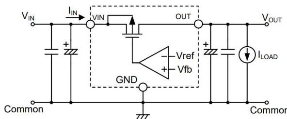
由于负载的瞬态性能，在实际应用中要求稳压器提供稳态和瞬态电流。虽然该系列芯片操作于限制范围内，并在其稳态电流下工作良好，但必须注意可能导致电流上升至接近极限参数的瞬态负载，这也将导致芯片结点温度的升高。电路中存在稳态电流和瞬态电流，最需考虑的应为芯片中产生热能的电流值均值，更确切地说是 RMS 值。下图显示了与瞬态电流相关的平均电流。
