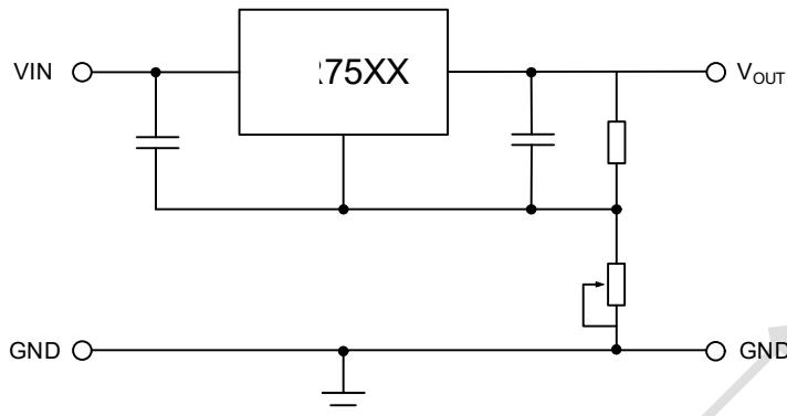
**10.4. 高输出电流正电压稳压应用电路**
